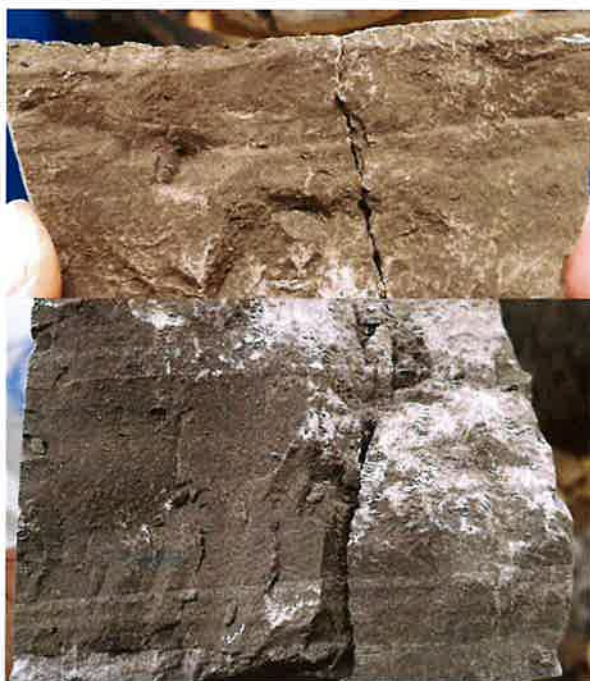
Slika 1: plastovitost in različna sestava preiskovanih kamnin, ki rezultira tudi v razliko ugotovljene gostote
