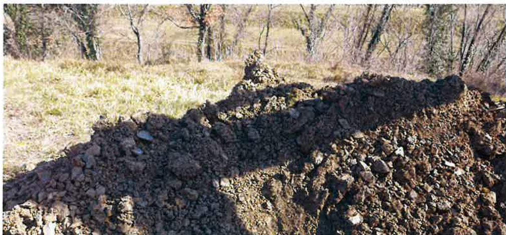
Slika 5: IG0a - organska zemljina s kosi laporovca in gradbenih odpadkov.
